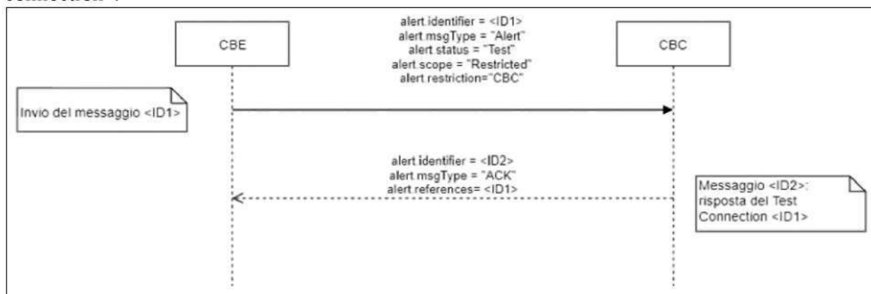
Figura 3. Servizio IT-Alert. Schema del flusso dei messaggi fra CBE e CBC nel caso di Test Connection.
