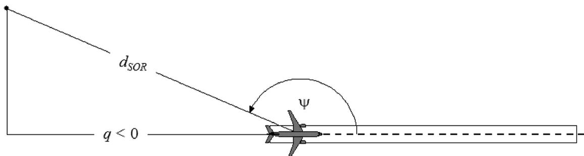
La funzione  $\Delta_{SOR}$  rappresenta la variazione del rumore complessivo emesso in fase di rullaggio a terra in fase di decollo misurato dietro l'inizio del rullaggio in relazione al rumore complessivo emesso in fase di rullaggio a terra in fase di decollo misurato lateralmente all'inizio del rullaggio e alla stessa distanza:
