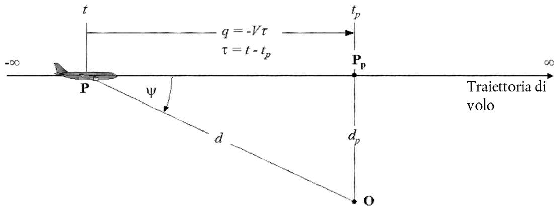
La **figura E-1** illustra la geometria della propagazione sonora tra la traiettoria di volo e il punto di osservazione **O**. L'aeromobile al punto **P** vola in un'atmosfera uniforme, ad una velocità costante, seguendo una traiettoria di volo livellato. Il punto della traiettoria più vicino al punto di osservazione è il punto **P<sub>p</sub>**. I parametri sono:
