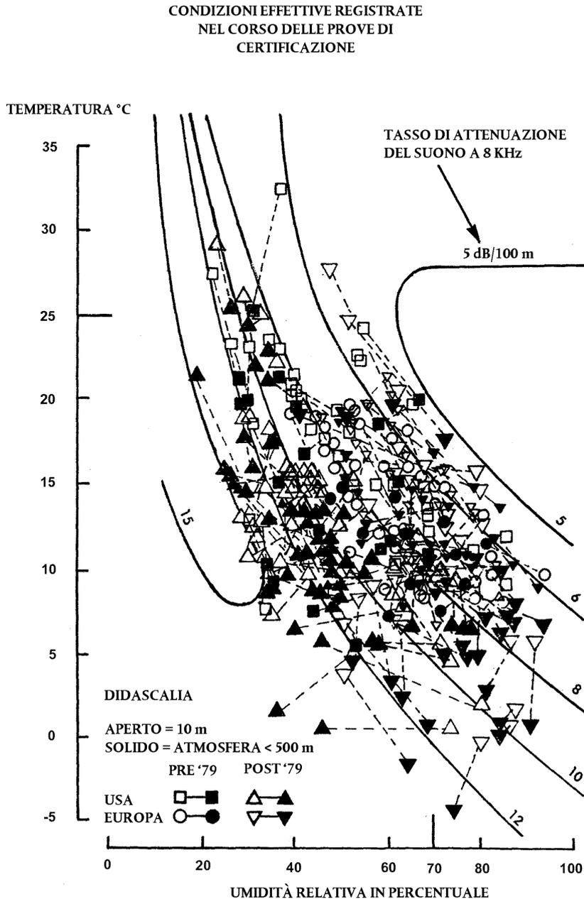
Le curve rappresentate nella **Figura D-1**, calcolate mediante il modello ARP 866A di attenuazione atmosferica standard industriale, indicano che, in condizioni di prova, dovrebbe verificarsi una variazione sensibile dell'assorbimento del suono ad alta frequenza (8 kHz) (anche se la variazione dell'assorbimento totale dovrebbe essere notevolmente inferiore).
