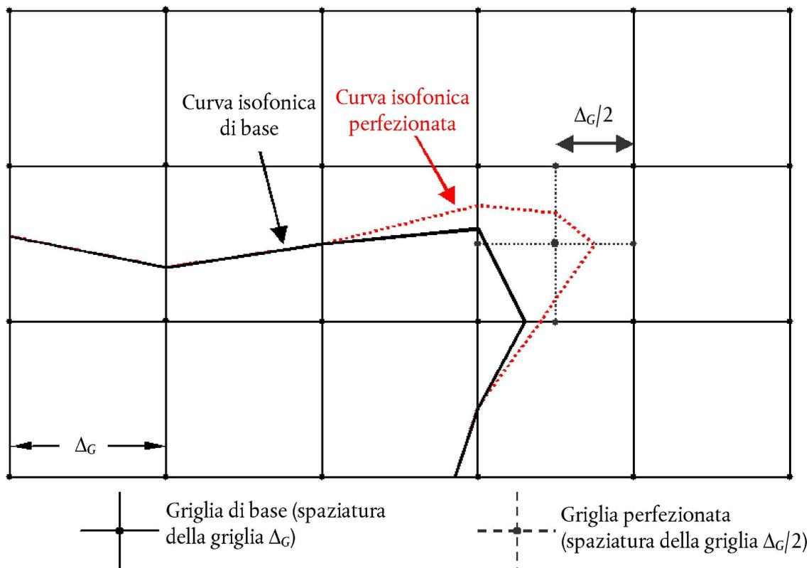
Un notevole miglioramento dell'efficacia dei calcoli con, di conseguenza, risultati più accurati, si ottiene utilizzando una griglia irregolare al fine di perfezionare l'interpolazione nelle cellule critiche. La tecnica, illustrata nella **figura 2.7.s**, prevede di restringere la maglia a livello locale lasciando inalterata la maggior parte della griglia. Si tratta di una tecnica semplice che può essere realizzata nelle seguenti fasi:
