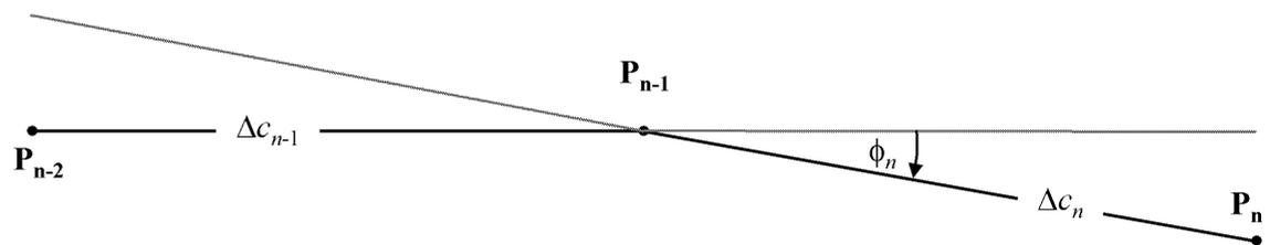
È necessario imporre determinate limitazioni per garantire che la curva isolivello sia stimata con un livello sufficiente di accuratezza (cfr. **figura 2.7.v**):
