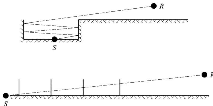
Nell'illustrazione, il raggio sonoro raggiunge il ricevitore «attraversando successivamente» i muri di sostegno della trincea, che possono quindi essere equiparati ad aperture.
