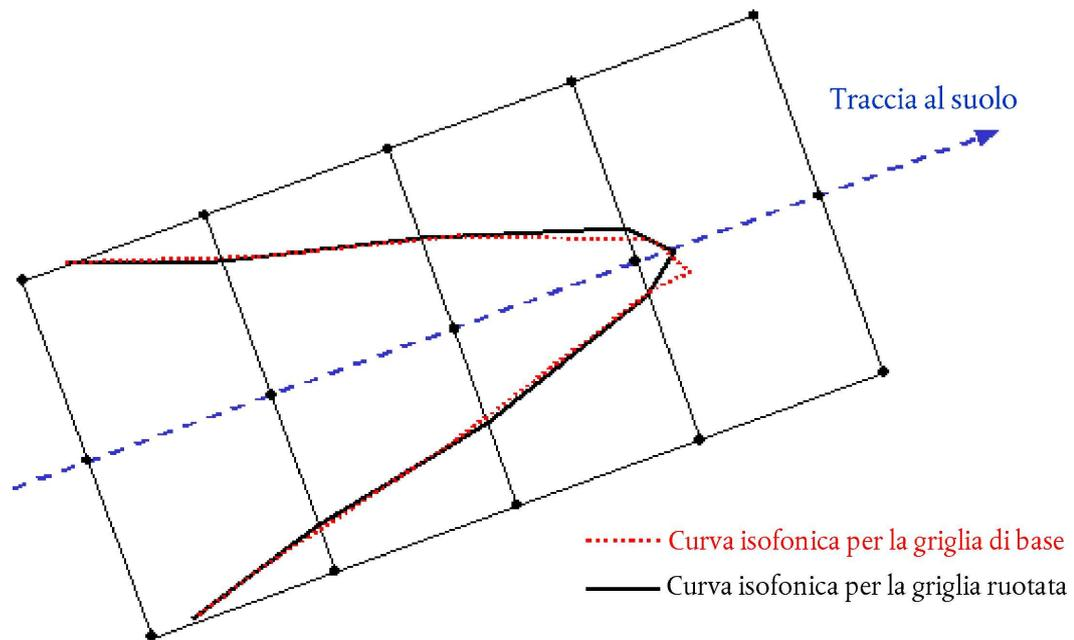
Un modo semplice per evitare questo effetto è quello di stringere la griglia, cosa che, tuttavia, causa un aumento dei tempi di calcolo. Una soluzione più elegante consiste nel far ruotare la griglia di calcolo in modo che la sua direzione sia parallela alle tracce al suolo principali (ovvero, di solito, parallela alla pista principale). La **figura 2.7.t** mostra l'effetto di tale rotazione della griglia sulla forma della curva isolivello.
