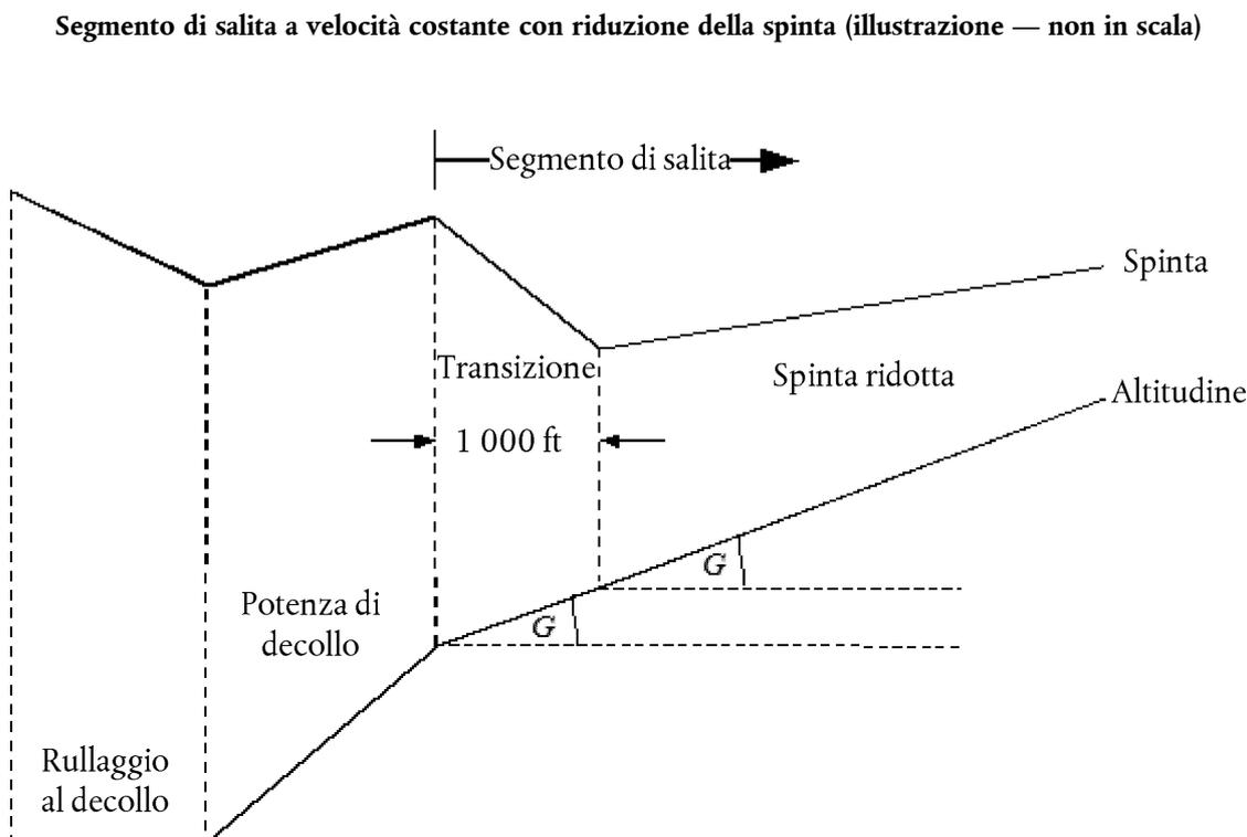
Il primo sottosegmento corrisponde ad una distanza al suolo di 1 000 ft (304 m) e la spinta netta corretta per motore al termine dei 1 000 ft è pari al valore della riduzione. (Se la distanza orizzontale originale è inferiore a 2 000 ft, una metà del segmento è utilizzata per ridurre la spinta). La spinta finale a livello del secondo sottosegmento è pari anch'essa alla spinta ridotta. Ne consegue che il secondo sottosegmento è percorso ad una spinta costante.
