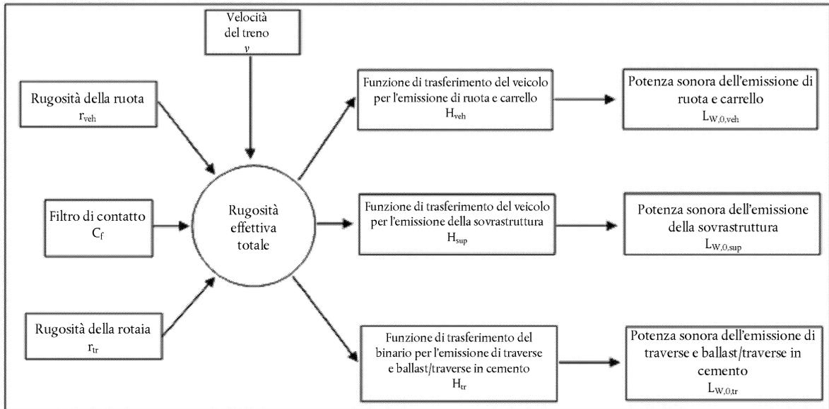
È necessario utilizzare una velocità minima di 50 km/h (30 km/h solo per i tram e la metropolitana leggera) per determinare la rugosità effettiva totale e quindi la potenza sonora dei veicoli (tale velocità non influisce sul calcolo del flusso di traffico) per compensare l'errore potenziale introdotto dalla semplificazione della definizione del rumore di rotolamento, dalla definizione del rumore di frenata e dalla definizione del rumore d'impatto dovuto a incroci e scambi.
