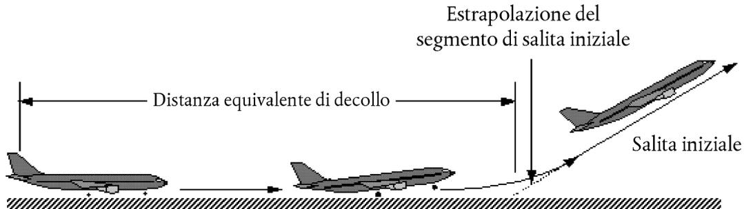
Su una pista piana, la distanza equivalente del rullaggio al suolo in fase di decollo  $s_{TO8}$  stabilita in piedi secondo la formula seguente:
