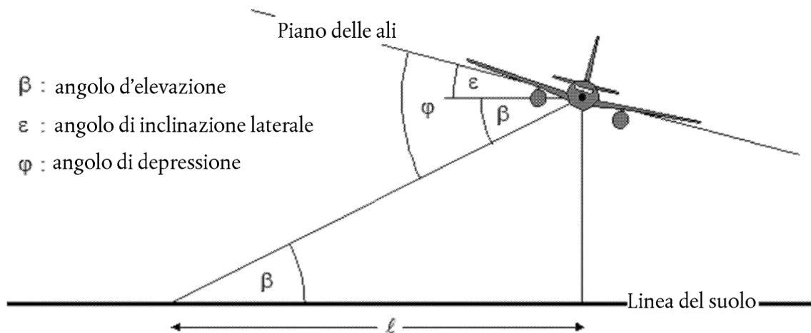
— L'angolo di elevazione  $\beta$  (compreso tra 0 e 90°) tra la traiettoria di propagazione diretta del suono e la linea del suolo <sup>(1)</sup> determina, insieme all'inclinazione della traiettoria di volo e lo spostamento laterale  $\ell$  del punto di osservazione dalla traccia al suolo, l'attenuazione laterale.
