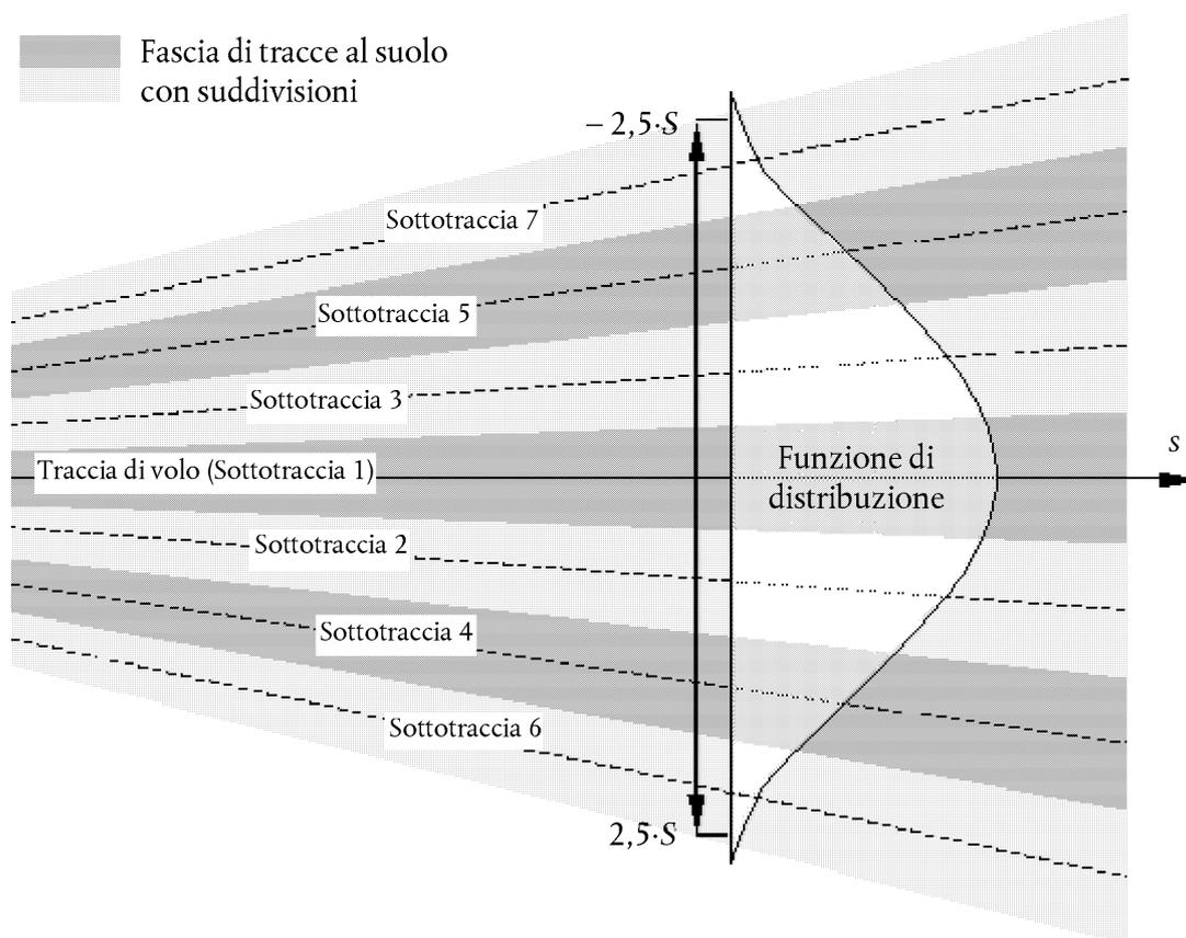
Di norma una distribuzione gaussiana può essere adeguatamente modellizzata utilizzando 7 sottotracce distinte equamente distanziate in una fascia di  $\pm 2,5 S$ , come illustrato nella **Figura C-1**.
