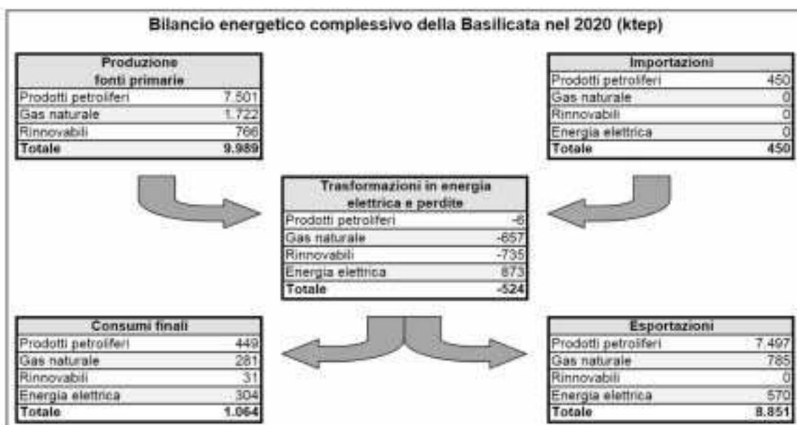
**Fig. 3<sup>42</sup> - L:** Schema di sintesi del bilancio energetico complessivo della Basilicata nel 2020<sup>42</sup>
